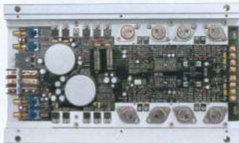
Geschirmtes Netzteil, SMD-Technik. Der Aufbau der Platine ist vom Feinsten.
